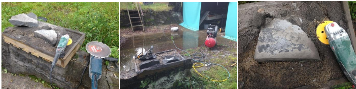
Den første grov slibning hvor stenen fræses og slibes i grundform
